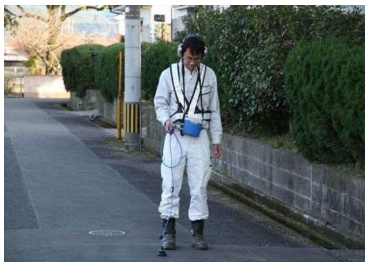
漏水調査状況
