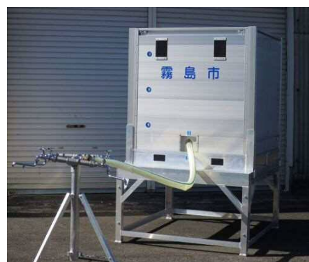
簡易給水タンク
