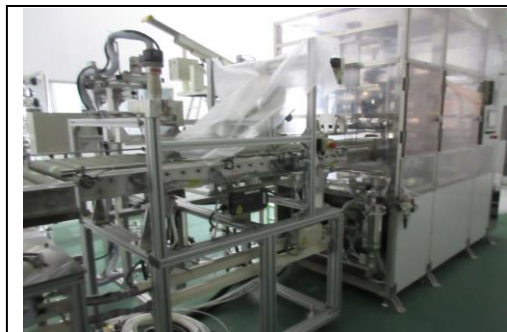
▲【BIB 充填機】 20L・10L 商品の注ぎ口にキャップシール（透明なフィルム）を自動装着する日本初の機能が装備されています。注ぎ口は、衛生面に配慮しゴミの付着や異物混入、汚れ防止のためキャップシールを装着しております。
