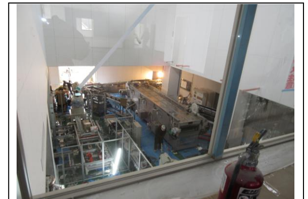
▲【製造ライン見学スペース】 2階ロビーの見学窓からは、20L・10L製品が箱詰めされる様子やペットボトルにラベルが自動で装着され箱詰めされる風景などご覧いただけます。
