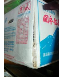
▲ 20ℓ箱の角が裂けた状態
