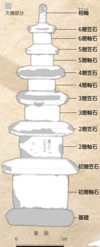
石塔の実測図(各部の名称)
